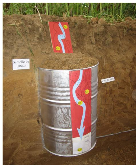
Photo 4. Maquette d'un lysimètre
